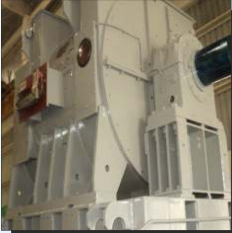
15MW, 11KV, Motor
